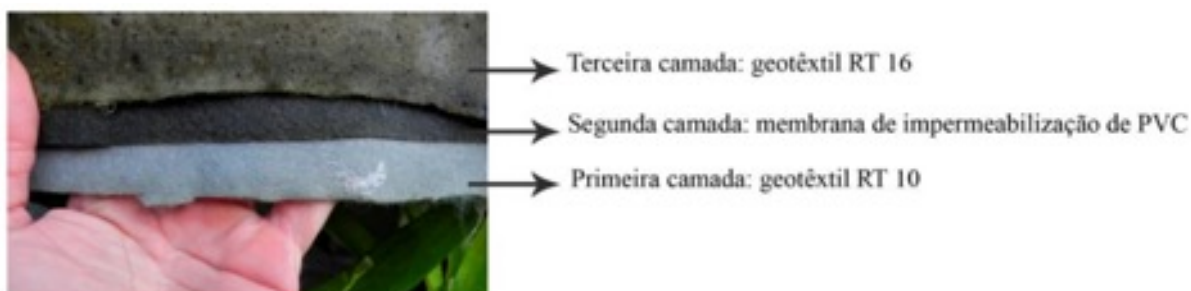
Figura 5. Materiais utilizados no telhado verde (SILVA, 2016)
