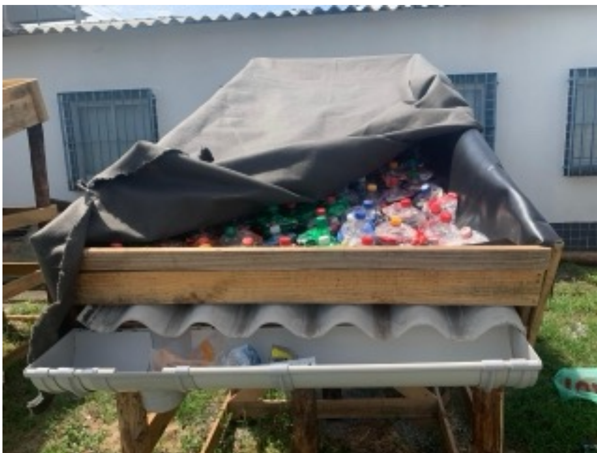
Figura 6. Protótipo 1 na etapa de colocação do geotêxtil (Fonte: EcoClima)
